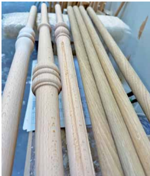
Tralki po toczeniu – powtarzalne w obrębie jednego projektu, ale rzadko wracające w identycznej formie. Produkcja odbywa się pod konkretne zamówienie, bez budowania magazynu półproduktów.
