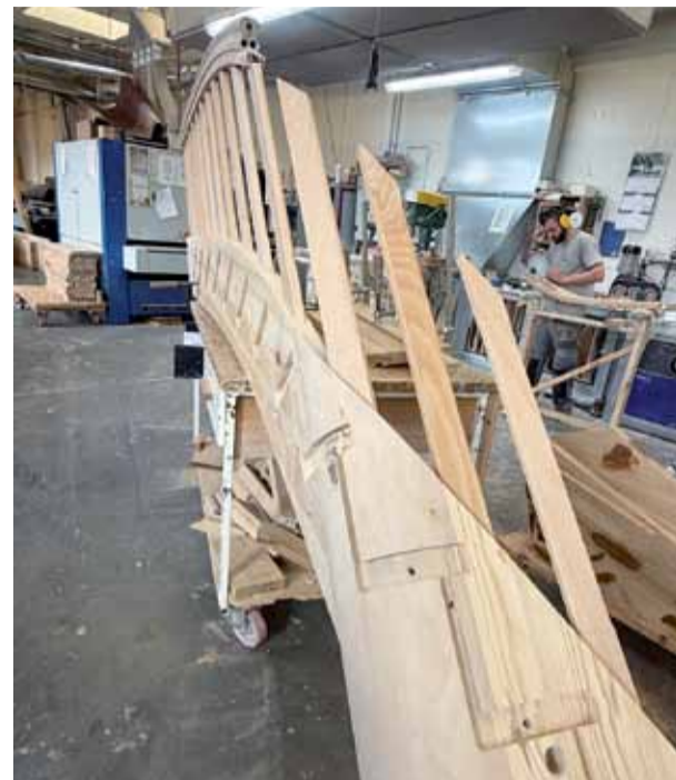
Element biegu schodów przygotowany pod dalszą obróbkę. Przy konstrukcjach giętych i niestandardowych każdy projekt oznacza inne parametry – długość, przekrój i profil zmieniają się niemal przy każdym zleceniu.
