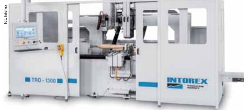
TRO-1300 to dwunastoosiowe centrum posiadające trzy noże typu „V” na kopiałach CNC, pozwalające na wydajną i precyzyjną obróbkę.
