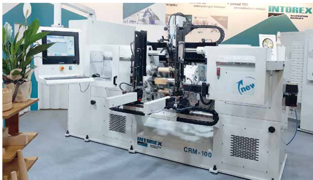
Rotacyjny automat tokarsko-szlifierski CRM-100 marki INTOREX cechuje większa wydajność i brak konieczności stosowania noży kształtowych do różnych modeli.
