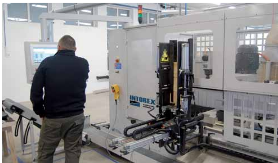
Wprowadzania danych na monitorze centrum dokonuje operator, ale zanim rozpocznie obróbkę elementów, uruchamia proces produkcji „na sucho”.
