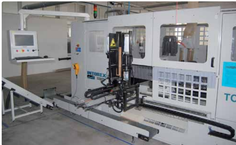
Jedyną ręczną czynnością jest załadunek elementów do magazynka maszyny i odbiór nóżek.
