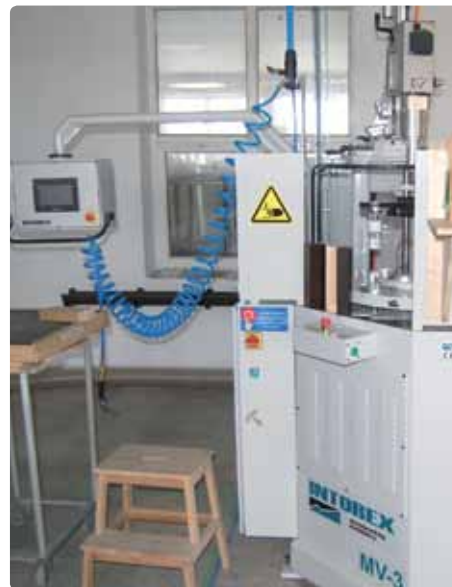
Do precyzyjnego wykonywania operacji wiercenia, wraz z centrami obróbczymi firma z Olecka zakupiła automat MV-3 firmy Intorex.
