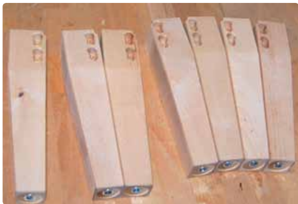
Maszyna firmy KOCH wykonuje precyzyjne frezowania w nóżkach.
