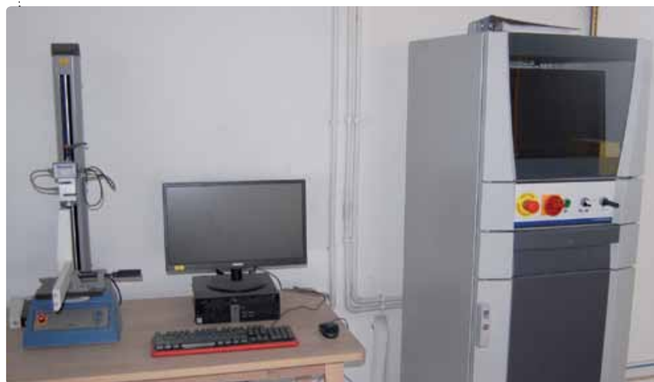
Interesujące i ważne jest stanowisko z urządzeniem pomiarowym brytyjskiej firmy Mecmesin do badania siły i momentu siły.
