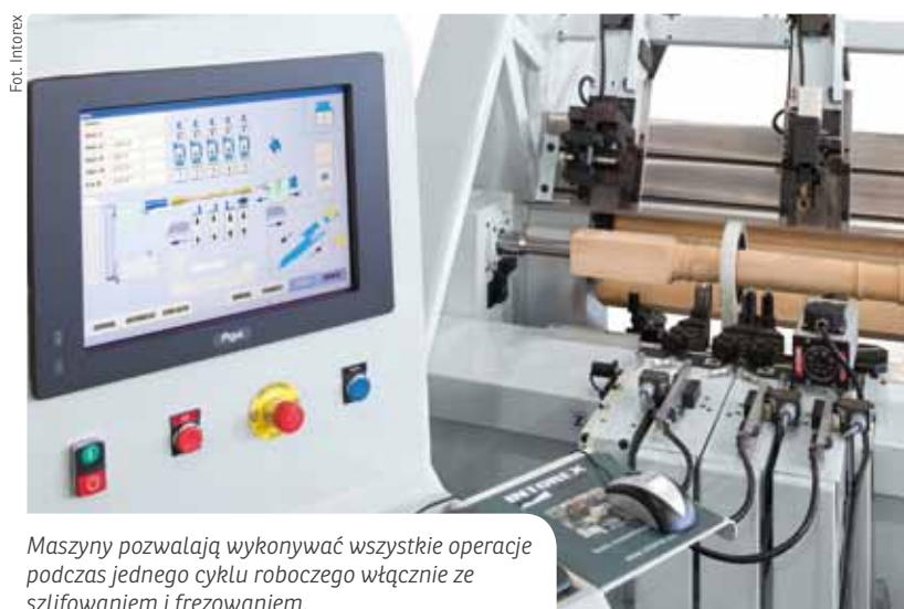
Centra obróbcze Intorexu posiadają opatentowany mimośrodowy system mocowania, z tak zwanym ekscentrycznym konikiem, dzięki czemu w czasie obróbki element można obracać o dowolny kąt.
