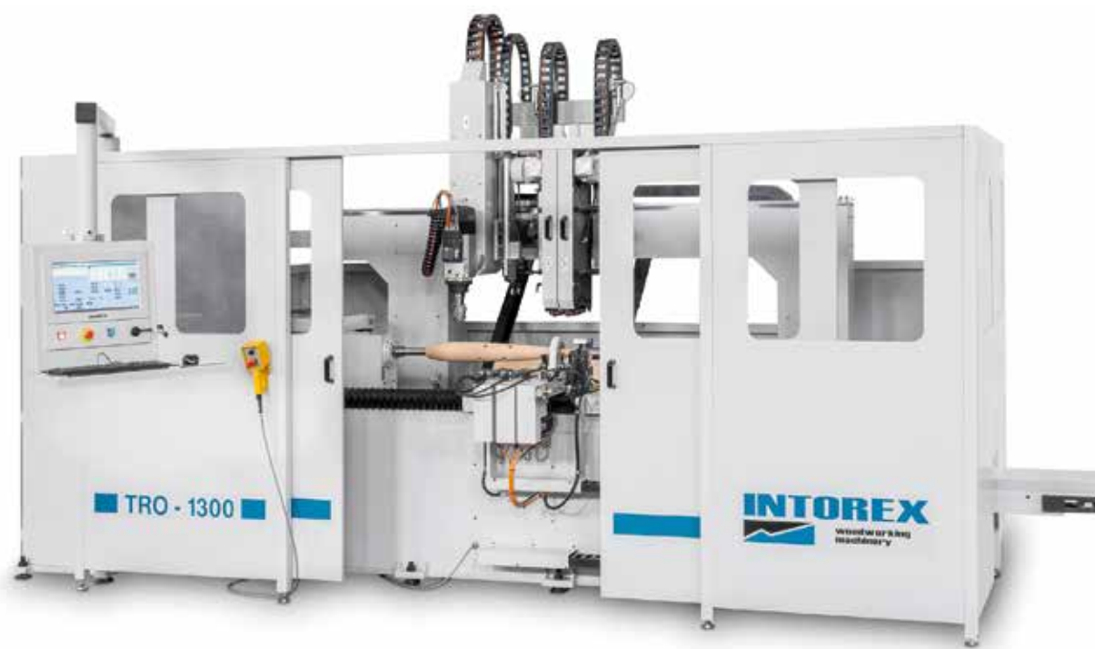
CNC TRO-1300 podzielony jest na dwie strefy pracy: dolną do toczenia z kopiałem do obróbki wstępnej i wykańczającej (ma również kopiał CNC z przodu lunety, do zaokrąglania kantówki do średnicy pierścienia lunety) oraz górną do szlifowania i dodatkowych operacji wiercenia czy frezowania za pomocą routera. Fot. INTOREX
