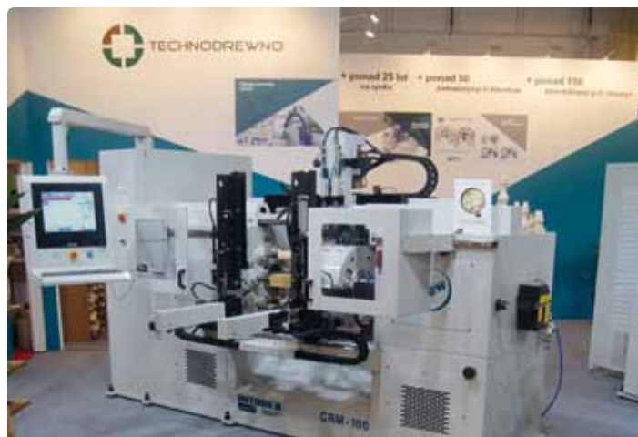
Tokarko-szlifierka CRM-100 stanowi doskonałą propozycję dla producentów zarówno małych, jak i dużych serii elementów drewnianych o długości do 300 mm.
