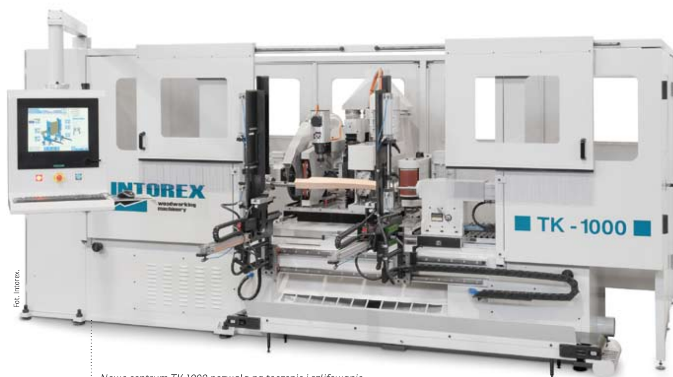
Nowe centrum TK 1000 pozwala na toczenie i szlifowanie po toczeniu oraz frezowanie i szlifowanie po frezowaniu.
