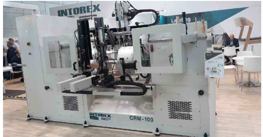
CRM-100 jest bardzo wydajnym automatem tokarsko-szlifierskim, pozwalającym na wyprodukowanie nawet 900 elementów w ciągu godziny. Fot. Aleksandra Lamek
