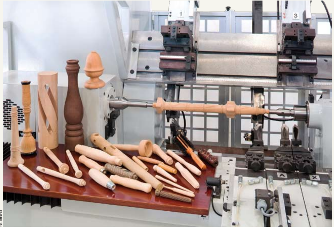
Intorex oferuje w pełni zautomatyzowane maszyny umożliwiające równoczesne toczenie i frezowanie w tym samym cyklu roboczym.
