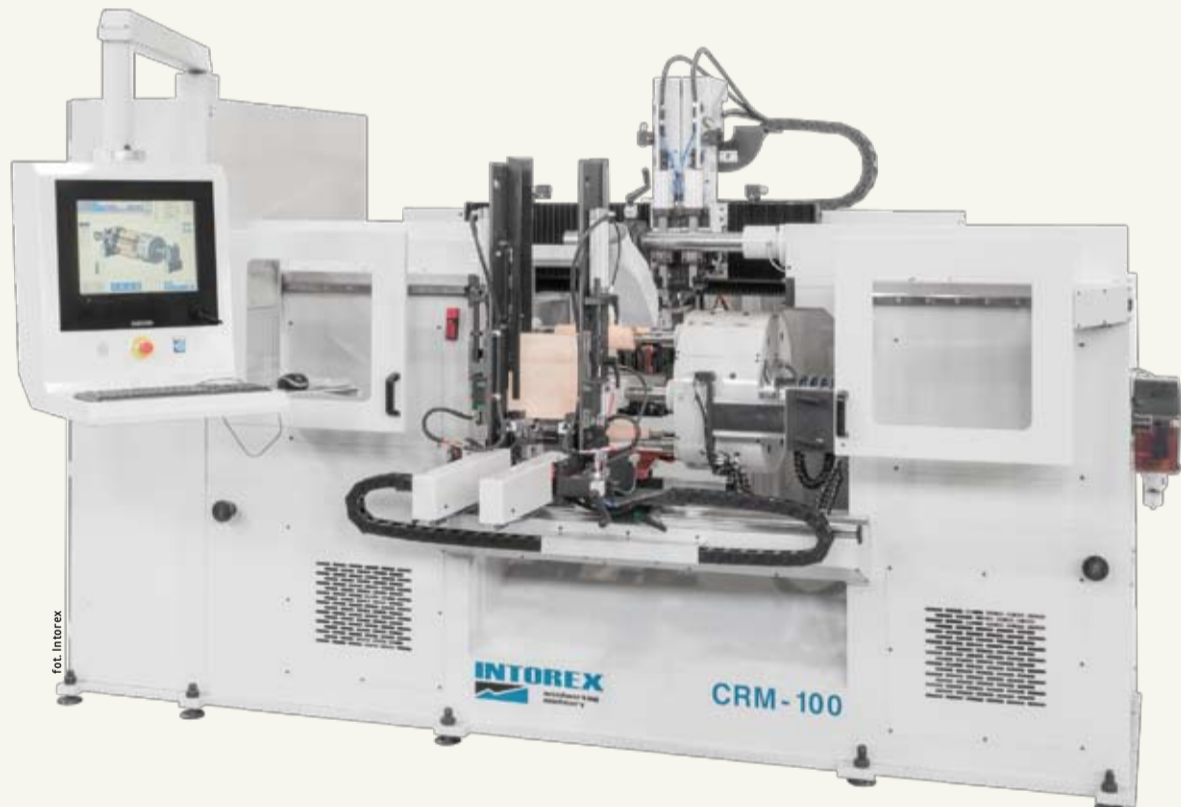
CRM-100 to numerycznie sterowana, rotacyjna tokarko-szlifierka pokazana premierowo na Lignie. Będzie ją można zobaczyć w tym roku na stoisku firmy Technodrewno w czasie targów Drema. Została zgłoszona także do konkursu o Złoty Medal MTP.
