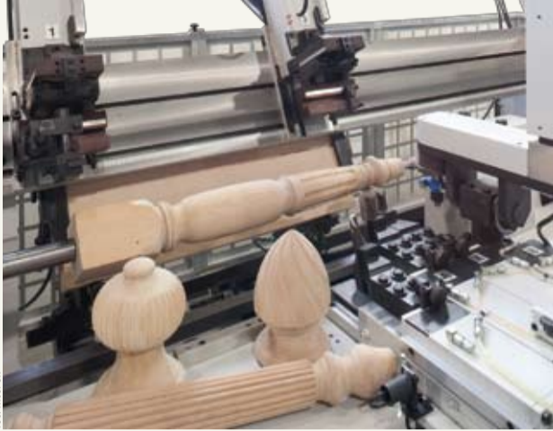
Wszystkie centra CNC Intorexu posiadają opatentowany mimośrodowy system mocowania z tak zwanym ekscentrycznym konikiem, dzięki czemu w czasie obróbki element można obracać o dowolny kąt i wykonywać toczenie, frezowanie, wiercenie czy szlifowanie.
