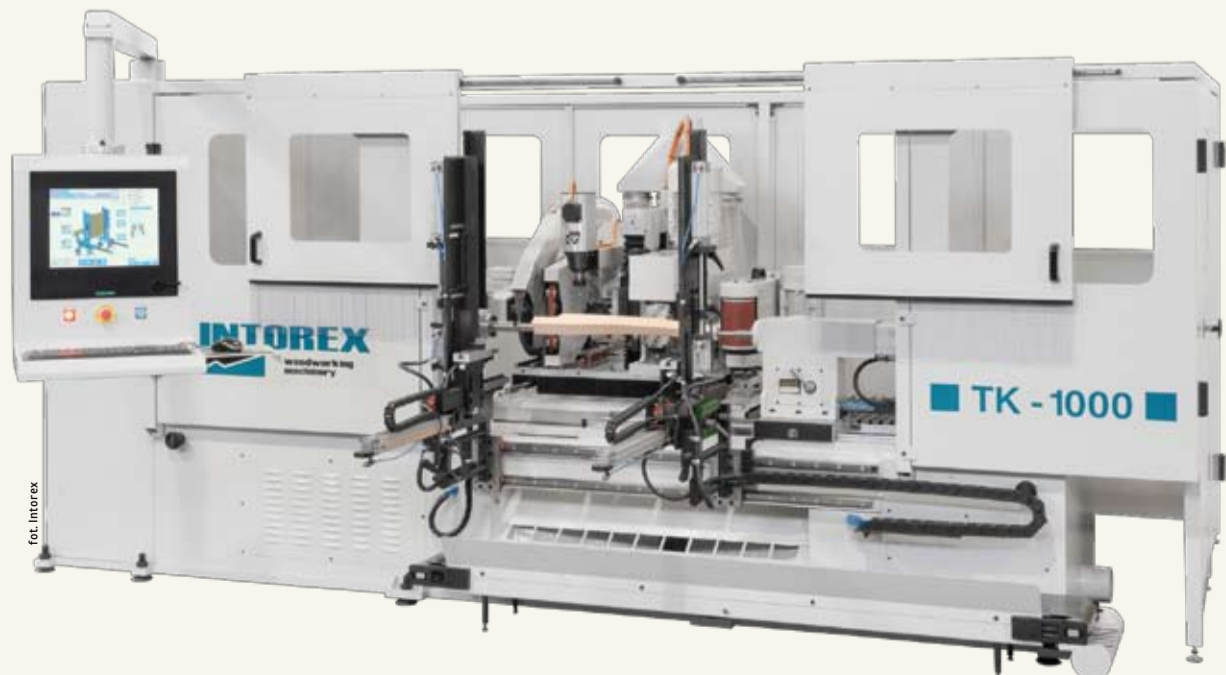
Nowe centrum TK 1000 pozwala na toczenie i szlifowanie po toczeniu oraz frezowanie i szlifowanie po frezowaniu. Posiada także dwie głowice wierząco-frezujące do wykonywania dodatkowych operacji.
