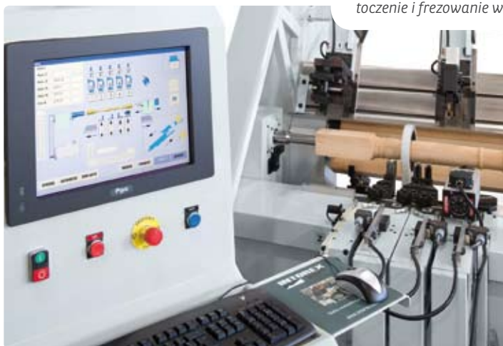
Numerycznie sterowane tokarki CKX to w pełni zautomatyzowane maszyny umożliwiające równoczesne toczenie i frezowanie w tym samym cyklu roboczym.
