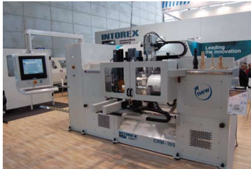
Swoją światową premierę na targach Ligna miała numerycznie sterowana, rotacyjna tokarko-szlifierka CRM-100, przeznaczona do produkcji elementów o maksymalnej długości 300 mm i przekroju 100 x 100 mm.
