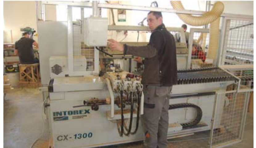
CX-1300 to w pełni zautomatyzowana tokarnia hydrauliczna wyposażona w dwa kopiały hydrauliczne i dwa komplety narzędzi formujących.
