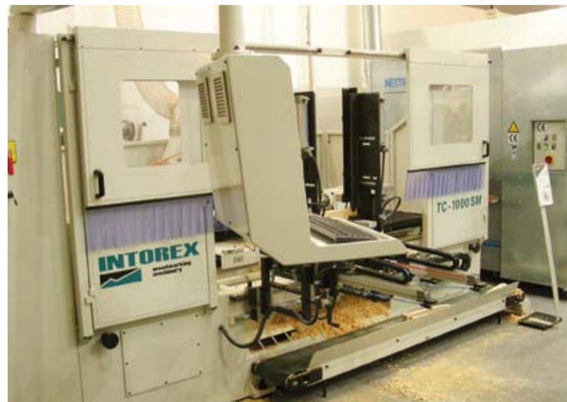
TC-1000 SM z pięcioma numerycznie kontrolowanymi osiami to wysokowydajna i elastyczna maszyna wyposażona w zespoły robocze umożliwiające frezowanie, wiercenie, profilowanie i szlifowanie.
