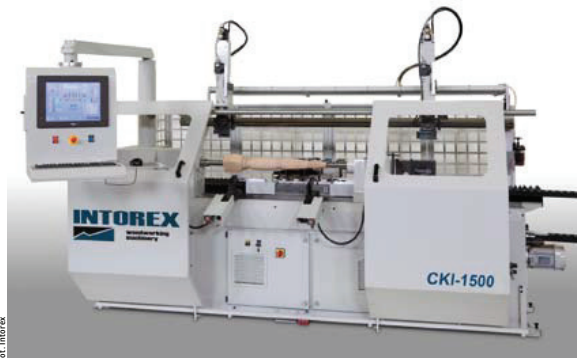
CKI-1500 to czteroosiowa numerycznie sterowana kopiałka wyposażona w dwa kopiały oraz hydrauliczny zespół cylindrujący.
